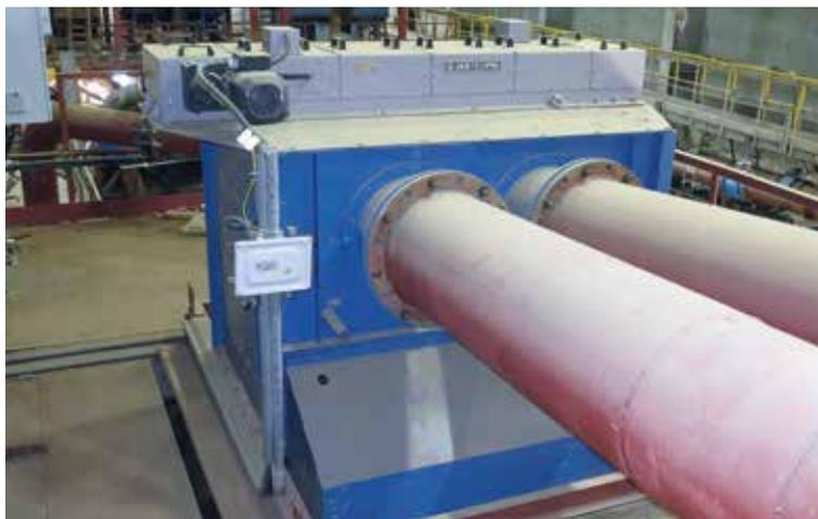
tor de drenaje. La posición de espera de la cuchara de muestra entre dos extracciones está dentro del espacio del material pero fuera del flujo principal del producto, de modo que se evita el contacto directo entre la cuchara de muestra y el flujo de material y se reduce el desgaste de la misma.
