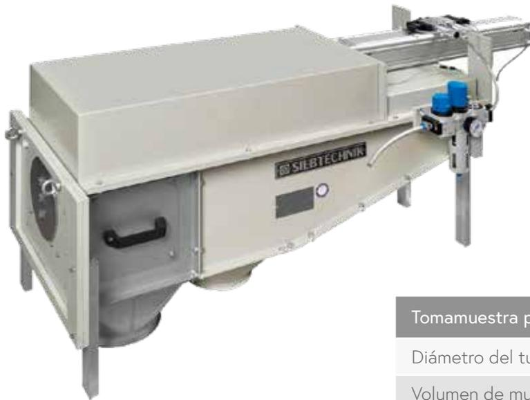
Cuando se retira la cuchara de muestreo, se extrae por medio de un pistón alojado dentro de la carcasa y la muestra de material se clasifica previamente mediante una rejilla rígida. El material fino obtenido de esta manera se puede transferir a un tubería de descarga para su posterior análisis. El material grueso se transfiere a una tubería adicional y es devuelto al flujo de material principal.
