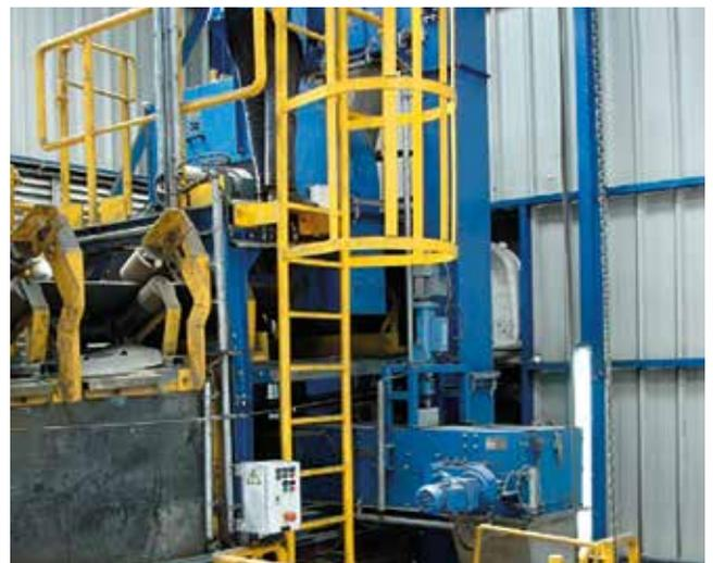
Instalación para la toma de muestra de concentrado de cobre
