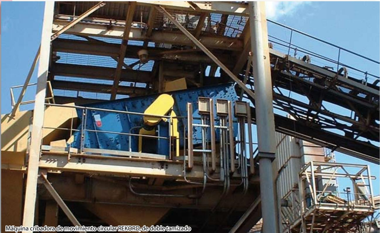
Máquina cribadora de movimiento circular REKORD, de doble tamizado
