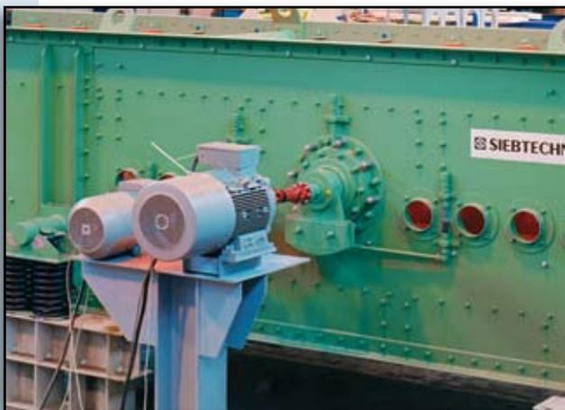
La conexión de interfaz Profibus al plc del cliente permite la programación de una cierta aceleración y parámetros elípticos según las condiciones variables de alimentación. También es posible programar un recorrido de lavado con elipsis vertical y aceleración máxima para expulsar los granos de tamaño inadecuado, previniendo de este modo atascos y reduciendo el tiempo de inactividad que causaría el necesario lavado manual.
