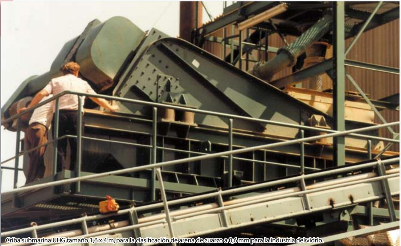
Criba submarina UHG tamaño 1,6 x 4 m, para la clasificación de arena de cuarzo a 0,6 mm para la industria del vidrio.
