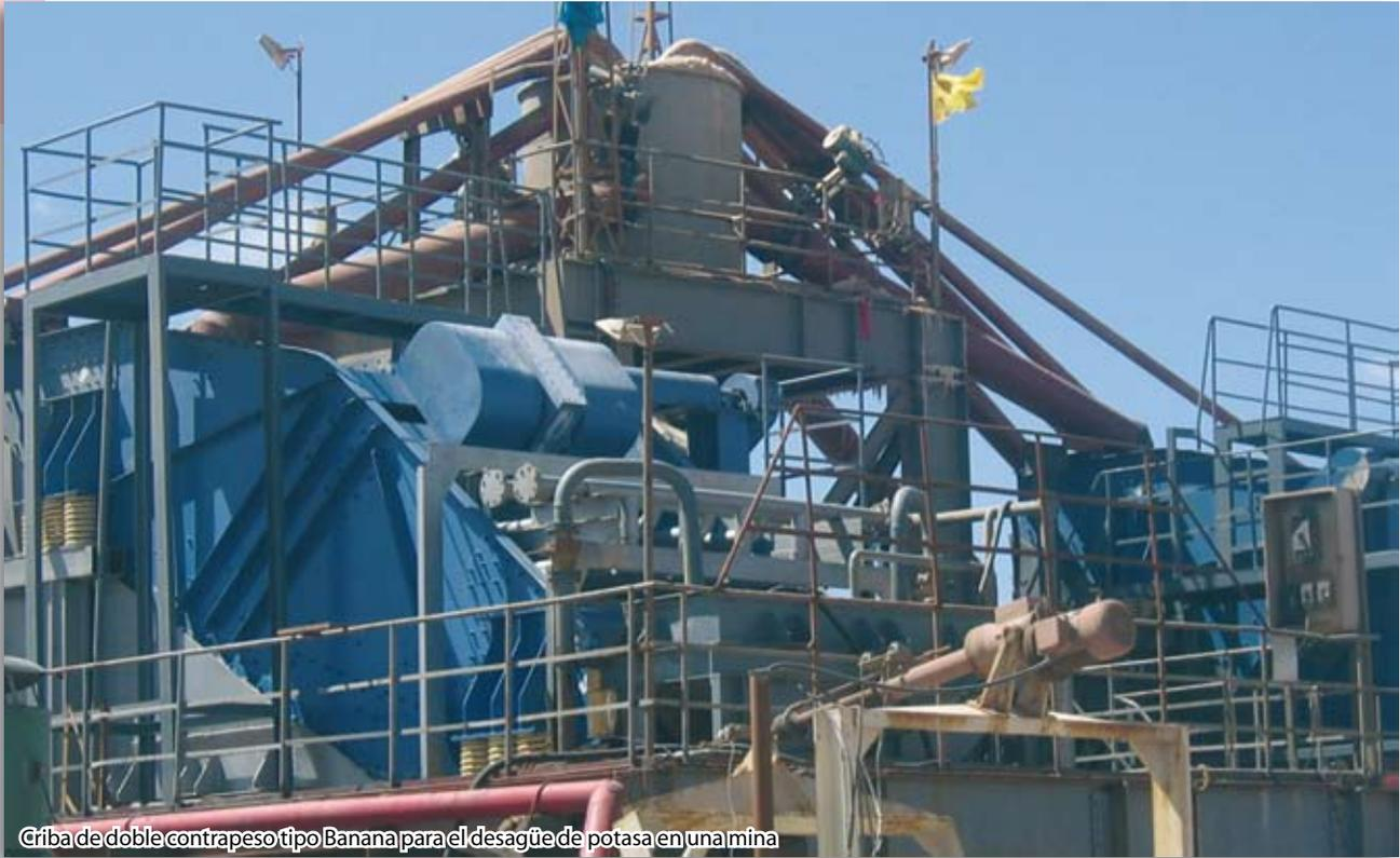
Criba de doble contrapeso tipo Banana para el desagüe de potasa en una mina
