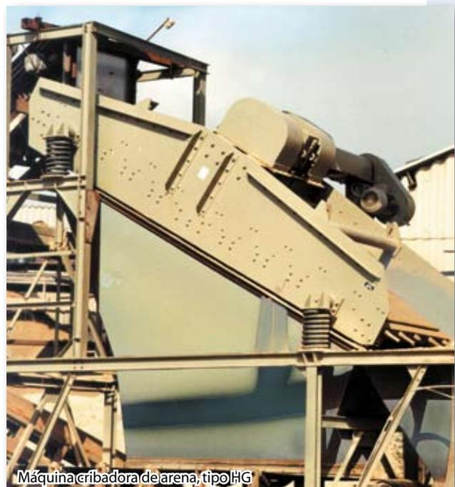
Máquina cribadora de arena, tipo HG
