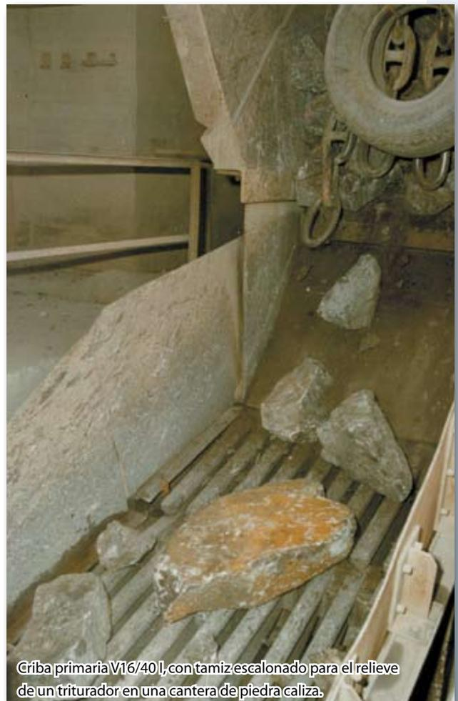
Criba primaria V16/40 I, con tamiz escalonado para el relieve de un triturador en una cantera de piedra caliza.
