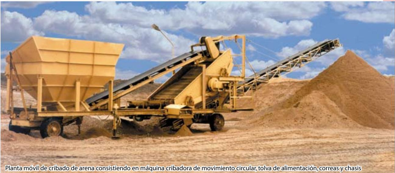
Planta móvil de cribado de arena consistiendo en máquina cribadora de movimiento circular, tolva de alimentación, correas y chasis
