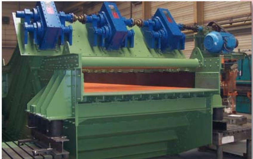
Una fila de 6 cribas cerradas de doble contrapeso tipo HG-C con transmisión debajo del tamiz para el tratamiento de residuos de incineración.
