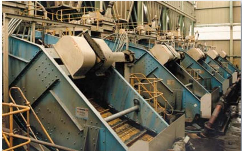
Criba Banana de doble tamiz tipo BHG 27/73 II para una mina de cobre en Chile.
