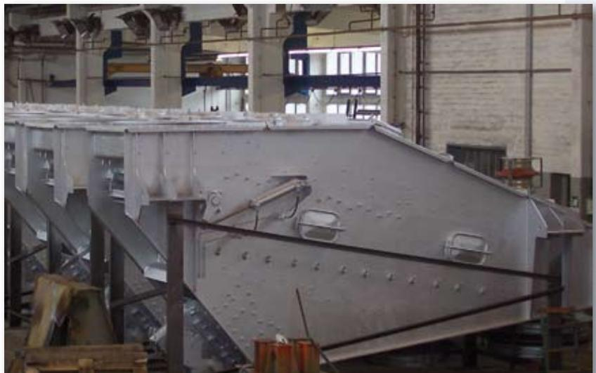
Criba de doble contrapeso HN, con cubierta antipolvo aislada, para la clasificación de agregado de asfalto a una temperatura de casi 400°C para montaje encima de una planta de mezclado de asfalto.
